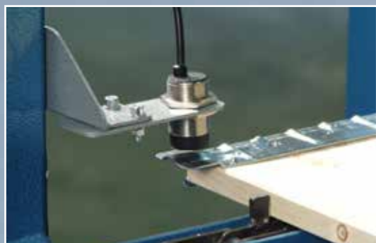
6. Сенсорный датчик контроля подачи петель
